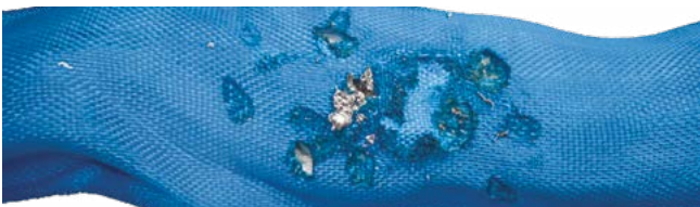
SALPICADURAS DE SOLDADURA EN LA ESLINGA.
