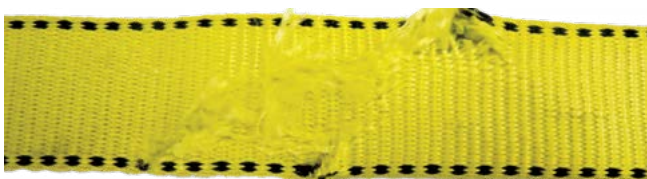
ATORAMIENTOS Y DESGARRES EN LA ESLINGA.
