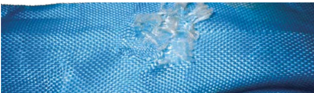
ATORAMIENTOS Y DESGARRES EN LA ESLINGA.
